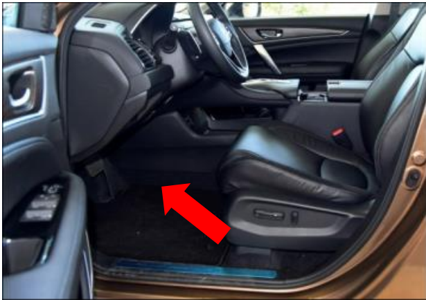
拆内饰件：把驾驶室左下角装饰件拆下，并妥善保管，后续还原安装。（箭头）
