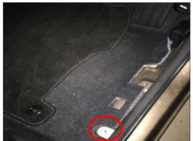
右穿线孔：掀开驾驶室垫脚海绵后，可看见车
