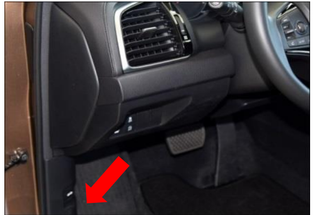
拆内饰件：在中控台左侧线盒内找正极接口；（箭头）
