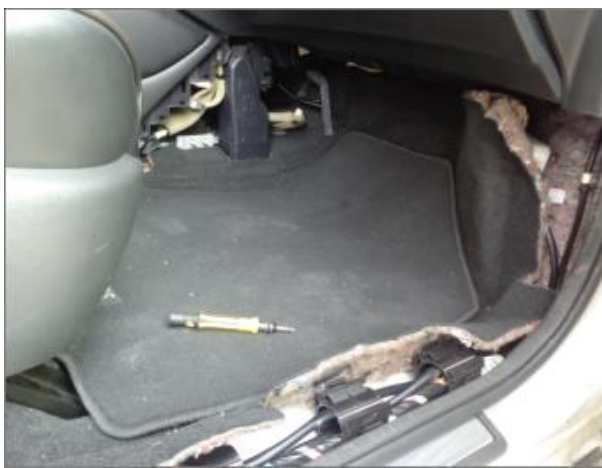
右穿线孔：电机线从电瓶此位置位穿过（图片仅供参考）
